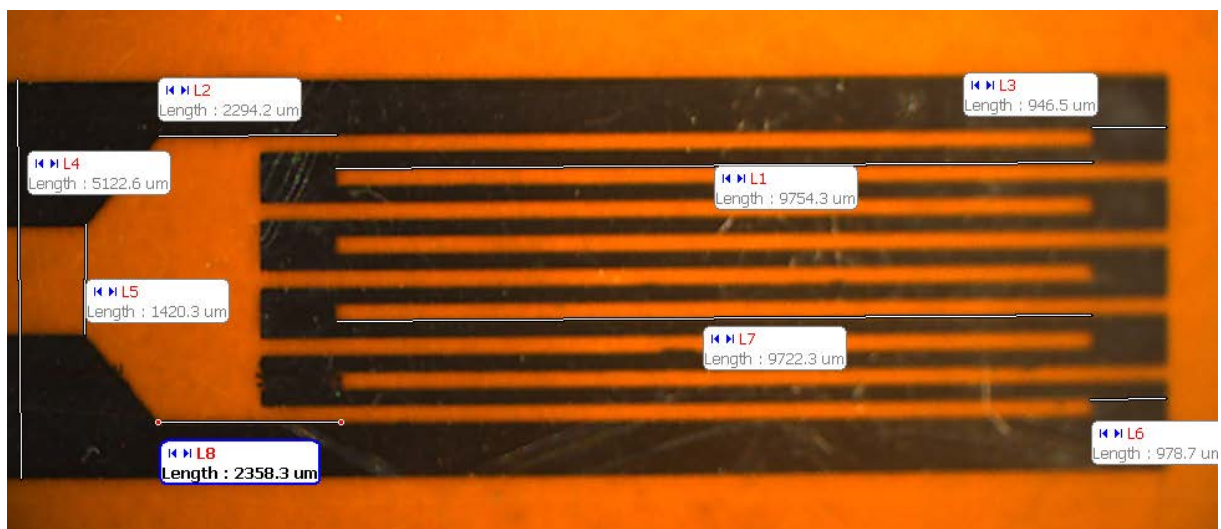
Slika 8. Ostvarene dimenzije odštampalog i sinterovanog senzora,
