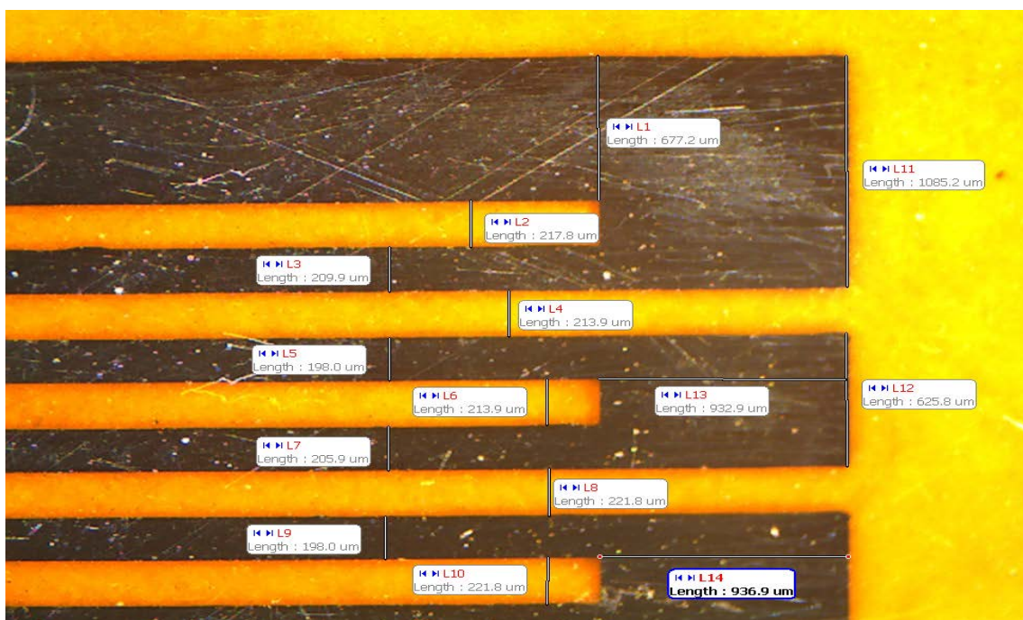
Slika 9. Ostvarene dimenzije odštampanih i sinterovanih linija sa većom magnifikacijom.
