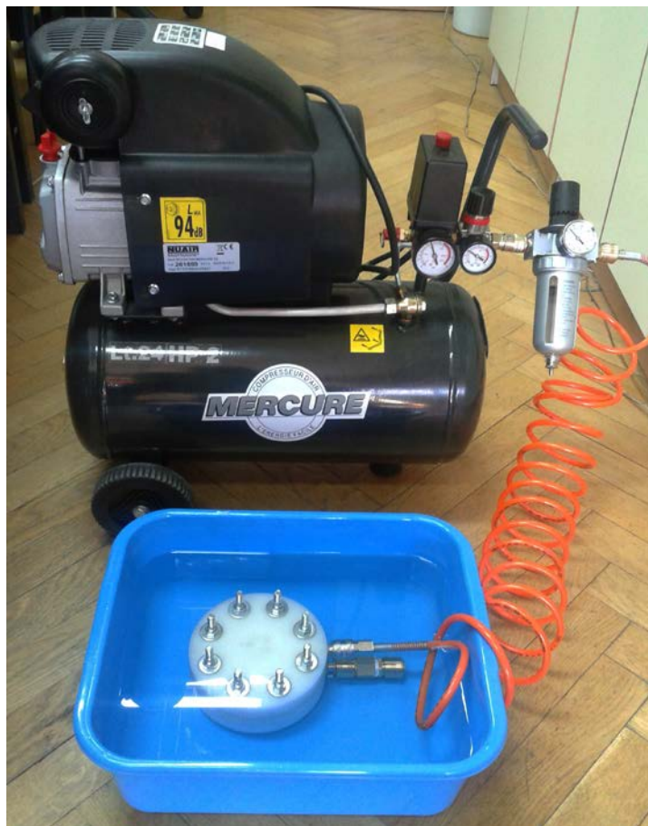
Слика 2. Поставка за тестирање држача сензора под водом
