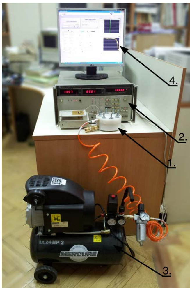
Слика 3. Мерна поставка за тестирање сензора притиска.
