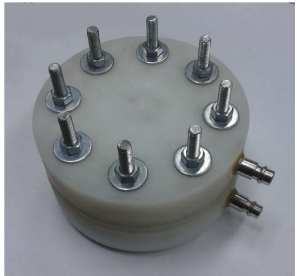
Слика 6. Спојени делови држача са убаченим сензором
