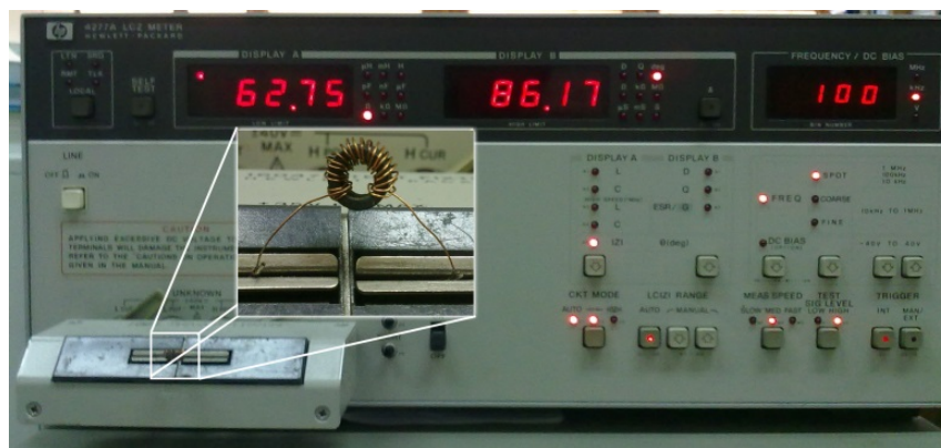
Слика 3. Мерна поставка за одређивање комплексне пермеабилности на нижим фреквенцијама.
