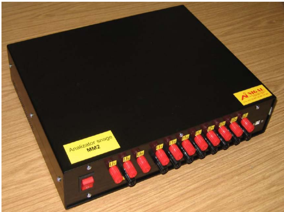
Slika 1. Industrijski prototip 2-bitnog dvostrukog trofaznog analizatora snage sa dodatim funkcijama merenja kvaliteta električne energije – oznaka tipa MM2
