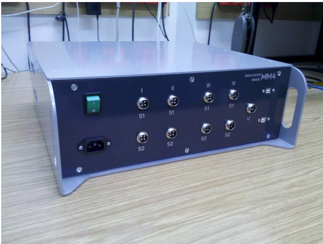
Slika 1. Serijski proizvod, 2-bitni četverostruki trofazni analizator snage sa dodatim funkcijama merenja kvaliteta električne energije – oznaka tipa MM4
